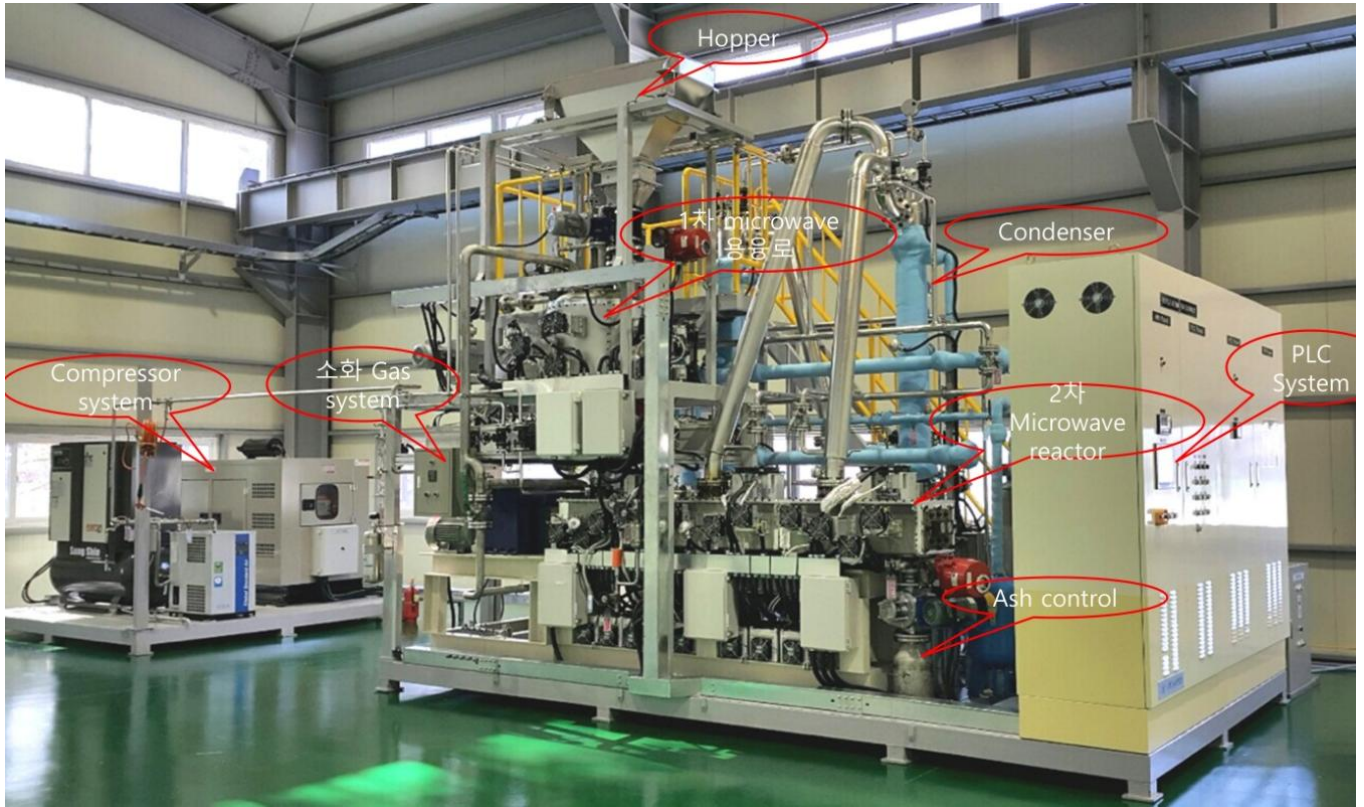
실장치 사진. 주석:Hopper, 1차 microwave 용융로, 2차 reactor, condenser, PLC system, compressor, ash control
